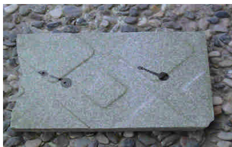
比較兩邊墨汁變化的差異，有塗光觸媒一邊墨汁比較不容易滲入磁磚
